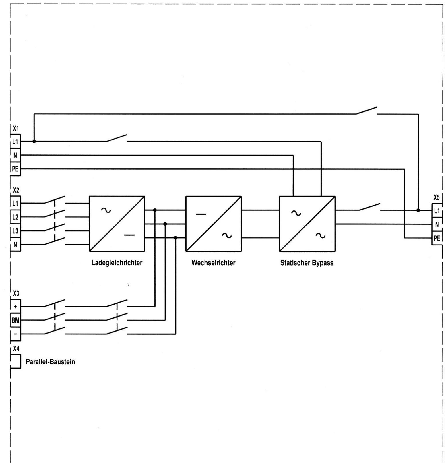
Bild 3e: Trennstellen innerhalb von USV-Anlagen (3/1) für HPR-Betrieb
